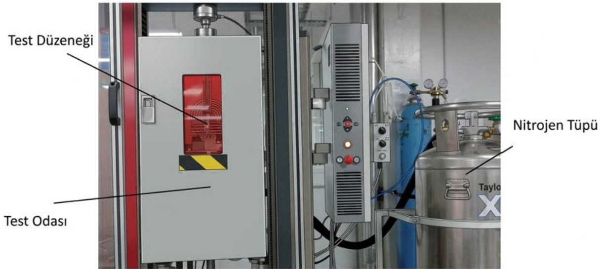
Şekil 1. Sıfır altı sıcaklıklarda 3 nokta eğme testi için kullanılan termal şartlandırma odası ve test düzeneği
