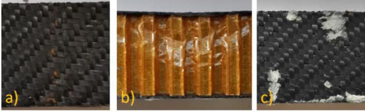
Şekil 14. -40°C’de 20 mm Nomex çekirdekli numunenin yükleme bölgesi yakın çekim görüntüleri; a) basma yüzeyi b) yan yüzey c) gerilim yüzeyi
